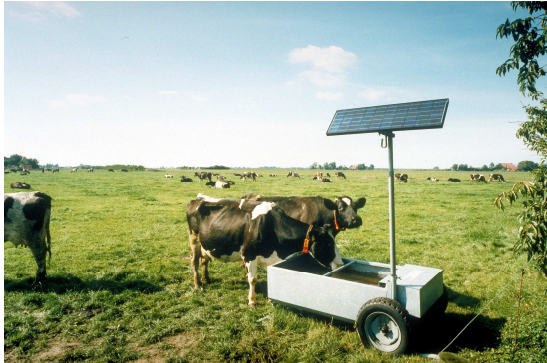
Zonnestroom in een toepassing zonder elektriciteitsaansluiting: een waterpomp in een weiland.
